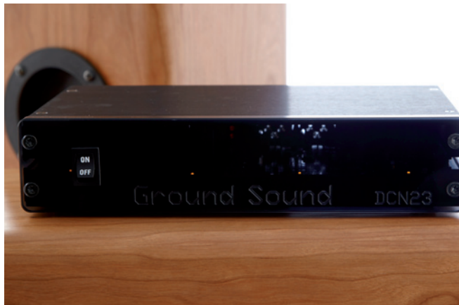
EIGENTLICH EINE AKTIVE DREI-WEGE-WEICHE FÜR LAUTSPRECHER, DIE INTELLIGENTE STEUEREINHEIT FÜR DIE OHM-WALSH AE 1000 IS
